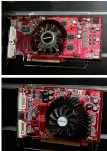
Radeon HD 2600 XT GDDR4 et GDDR3 chez Powercolor. La première dispose de mémoire plus vélocité mais le GPU est identique.
