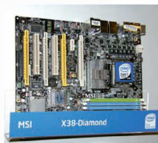
La carte mère X38 de MSI fait appel à un composant supplémentaire pour disposer de plus de lignes PCI-Express, sans que nous ne sachions quelle est la limitation exacte. Notez que le X38 est recouvert d'un heatspreader, comme les CPU.
