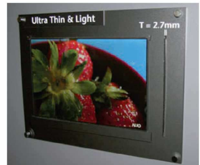
AUO présentait une dalle 13,3" pour portables utilisant la technologie LED et épaisse de seulement 2,7 mm.
