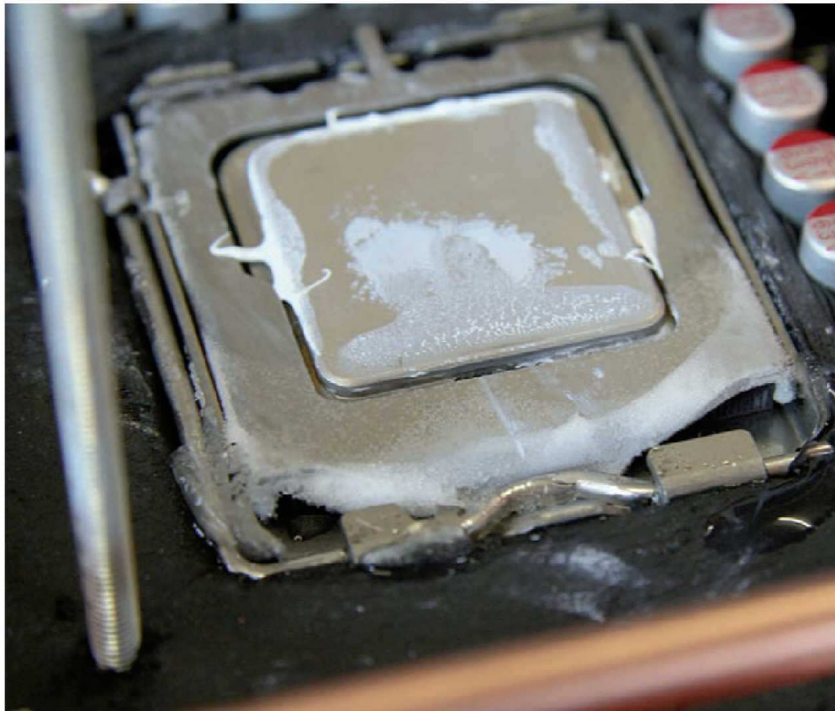
Le plus gros problème du refroidissement extrême est le gel qui se forme autour du socket.
