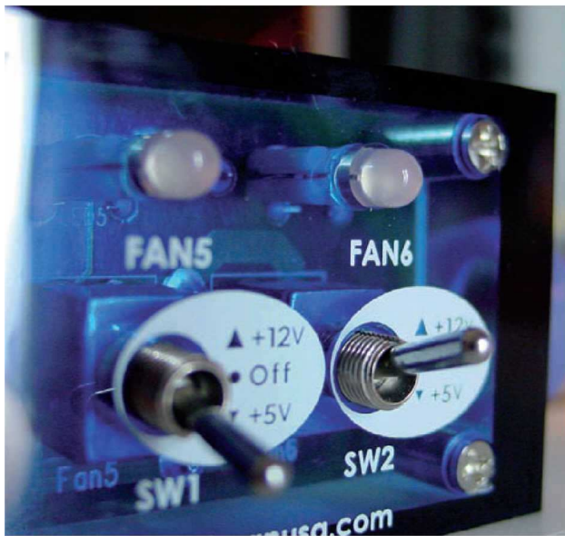
Des rhéobus sont parfois dotés d'interrupteurs permettant de délivrer 0,5 ou 12 V au ventilateur.
