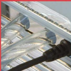
Une equerre permet de faire passer les tubes et le connecteur +12 V qui permet au Reserator de s'allumer en même temps que le PC.
