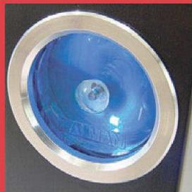
Tout y est, il ne reste plus qu'à démarrer la machine et l'indicateur de flux se met à tourner pour indiquer que tout fonctionne.
