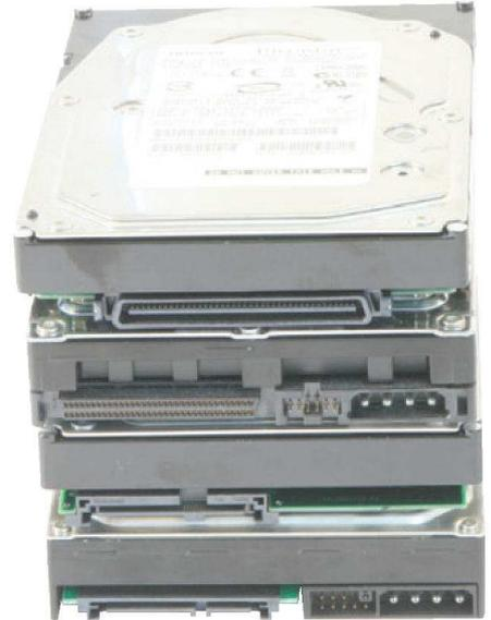
De haut en bas, un disque dur SCSI SCA, un disque dur SCSI classique, un disque dur SAS et un disque dur SATA.
