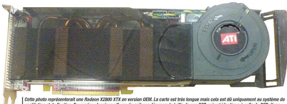
*Cette photo représenterait une Radeon X2800 XTX en version OEM. La carte est très longue mais cela est dû uniquement au système de ventilation et de fixation. En version classique elle ne devrait pas dépasser la taille de son PCB qui est identique à celle du PCB d'une Radeon X1900 ou d'une GeForce 8800 GTS, la 8800 GTX étant elle plus longue.*
