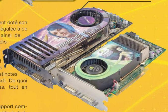
comparer les 128 pipelines « x1 » de la GeForce 8800 à 24 + 8 pipelines « x4 » de la GeForce 7900. Autrement dit, à fréquence égale, la puissance de calcul de ces 2 GPU est identique. Mais le rendement est tout autre grâce à l'architecture scalaire, mais également grâce à l'architecture unifiée qui permet de répartir d'une manière optimale la puissance de calcul entre les vertex shaders et les pixels shaders.
