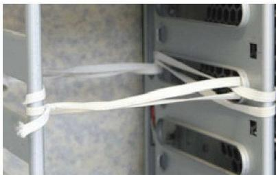
Une suspension réalisée avec des élastiques permet d'empêcher toute transmission des vibrations du disque au boîtier. La diminution du bruit est parfois impressionnante.
