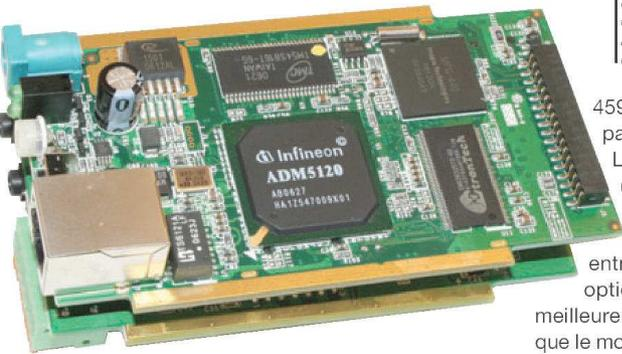
Une caméra IP embarque un processeur, de la mémoire et un système d'exploitation réduit au minimum. C'est ce qui lui permet d'intégrer un serveur http.
