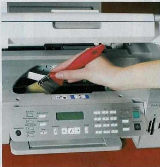
caoutchouc. Prenez en main la cartouche ou le dispositif qui accueille les têtes d'impression et passez dessus un chiffon (ou un bâtonnet à embout en mousse) à peine humidifié par de l'eau déminéralisée. Dès que le chiffon est encrassé, changez-le. Procédez en douceur pour ne pas abîmer les circuits imprimés. Remplacez le dispositif, et tentez une nouvelle impression. Si par malheur les tirages sont toujours défectueux, il faudra remplacer la tête d'impression par une nouvelle.
