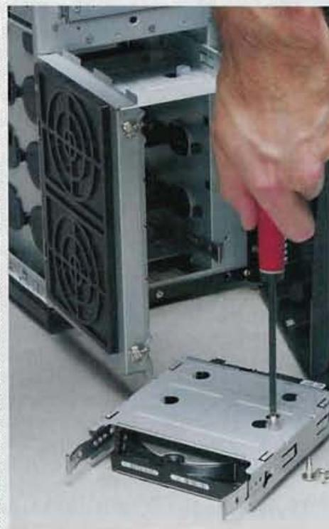
Le second système utilise un tiroir sur lequel on visse le disque à l'aide de vis que l'on glisse dans un caoutchouc qui sert d'amortisseur. Les vis se fixent sous le tiroir, puis ce dernier se glisse dans le PC ■
