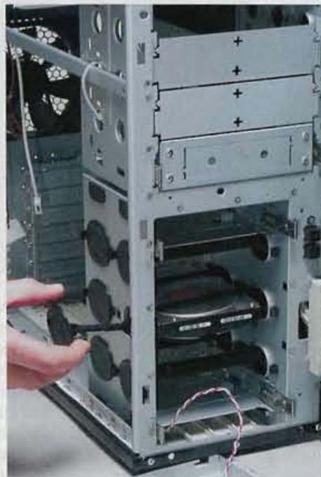
Le système des élastiques est le plus simple. Il suffit de les enrouler autour du disque pour le maintenir en place et absorber ses vibrations et une bonne partie du bruit qu'il génère. N'hésitez pas à retirer les tiroirs pour monter les disques avec plus de facilité. Seul défaut de ce système : les disques peuvent glisser lors du déplacement de l'unité centrale. Si cela vous fait peur (parce que vous la bougez souvent, par exemple), reportez-vous au deuxième système de fixation.
