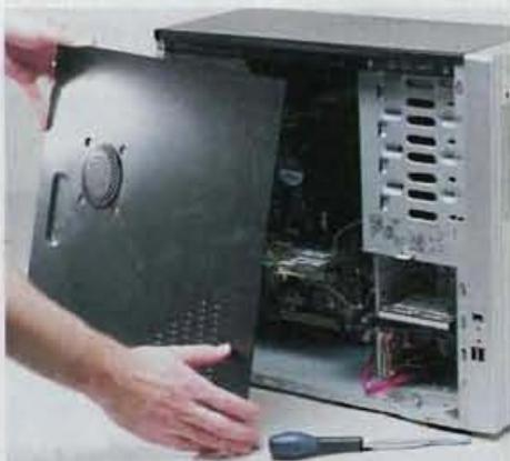
Eteignez le PC et débranchez-le du secteur. Détachez tous les câbles des périphériques raccordés au boîtier : imprimante, scanner, réseau, clavier, souris, écran, etc. Ouvrez le boîtier en dévissant les vis du panneau latéral et en faisant coulisser ce dernier vers l'arrière. Certains boîtiers s'ouvrent beaucoup plus facilement, sans vis, simplement en actionnant une petite poignée.
