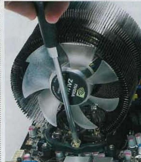
Posez ensuite le ventilad sur le processeur en passant la tige de maintien à travers son pied. Fixez la tige de part et d'autre du renfort grâce aux deux vis toujours livrées avec le ventilad.
