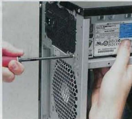
Rien de plus facile que d'installer une alimentation : placez-la dans le nouveau boîtier, en haut, câbles vers l'intérieur, en veillant bien à orienter le ventilateur vers le bas.
