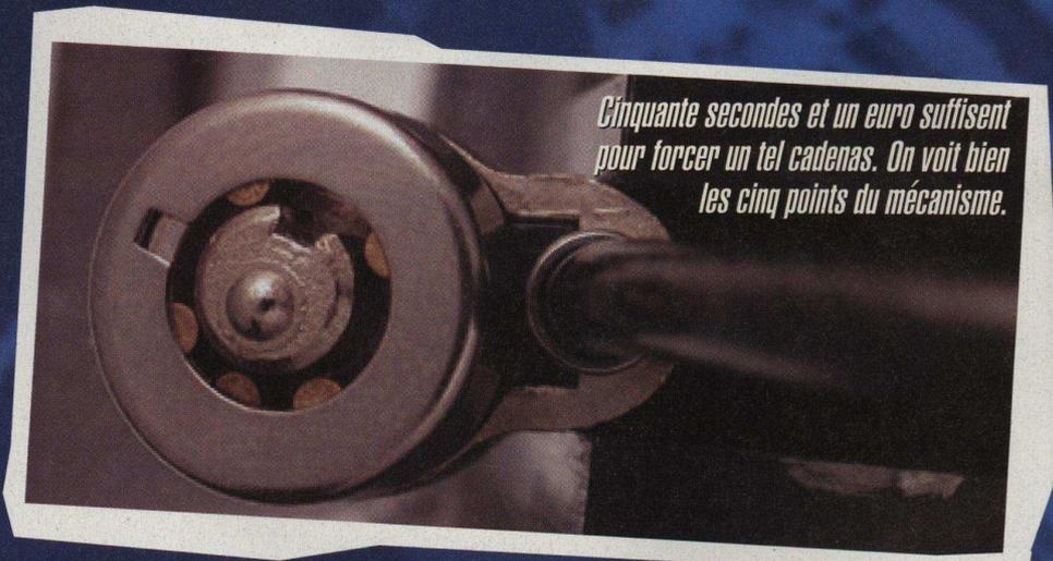
*Cinquante secondes et un euro suffisent pour forcer un tel cadenas. On voit bien les cinq points du mécanisme.*
