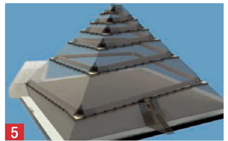
5 Suivant l'hypothèse de Houdin, le haut de la pyramide aurait été réalisé grâce à un système de rampe en spirale, situé à l'intérieur du monument.
