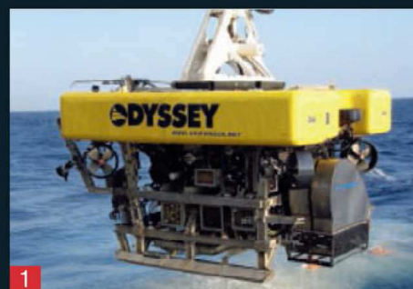
Un matériel de pointe. Zeus est un robot de 8 tonnes qui peut travailler à 2 500 mètres de profondeur avec des bras articulés.
